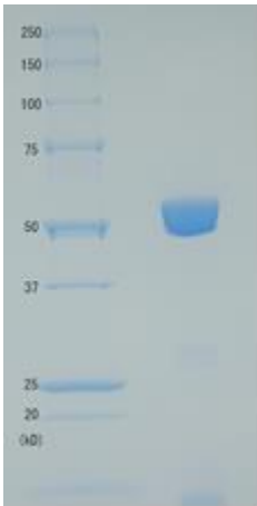
図 1. ジフテリア毒素変異体 CRM197 の SDS-PAGE (メルカプトエタノール非添加)
